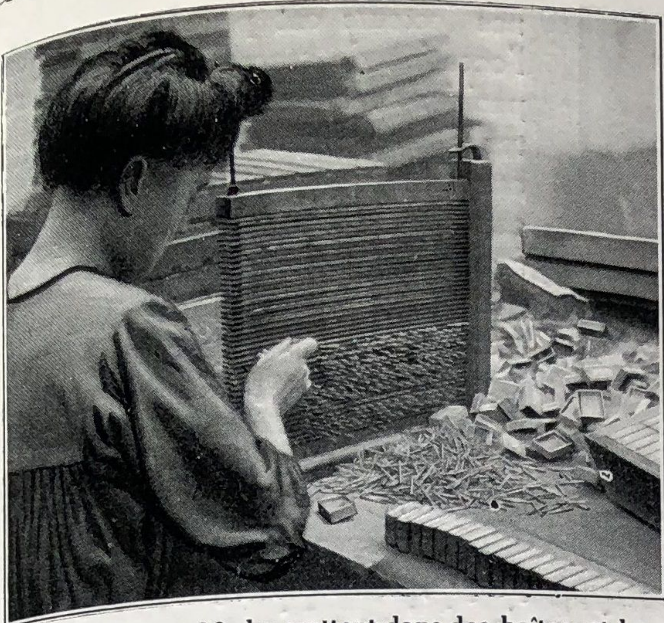
... les comptent par 30, les mettent dans des boîtes, et lorsqu'elles en ont un certain nombre, elles les portent au vérificateur qui prélève 2 ou 3 boîtes afin d'en vérifier le
